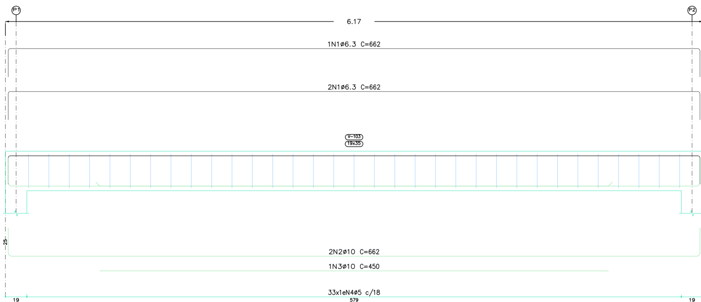
PLANTA ARMAÇÃO DE VIGA ESC. 1:50
